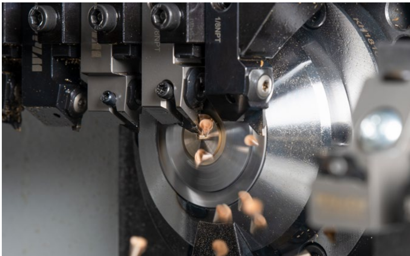
Tournage à profondeur de coupe élevée, 8 mm, avec la gamme de produits exclusive WhizCut. Résultat: contrôle accru des copeaux et excellente finition de surface.
